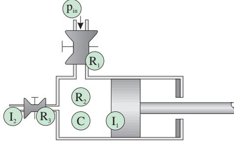
**Fig. 1.** Model parameters of a hydraulic actuator.
